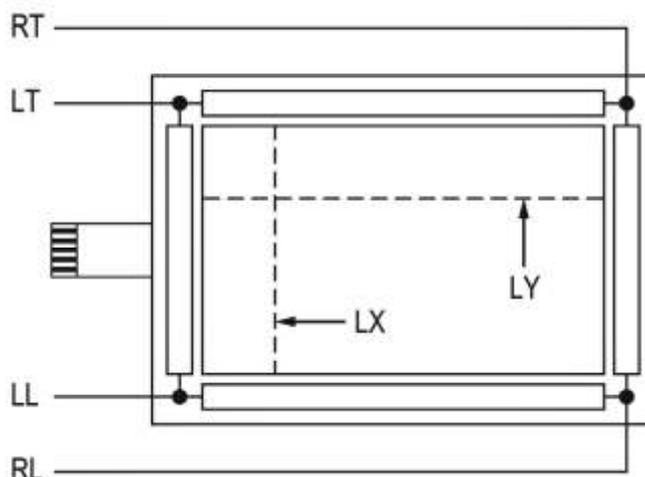
Hinweis: Schleifenwiderstand X = Kurzschluß von RT und RL, Kurzschluß von LT und LL, zu messen ist der Widerstand zwischen RT und LT.
